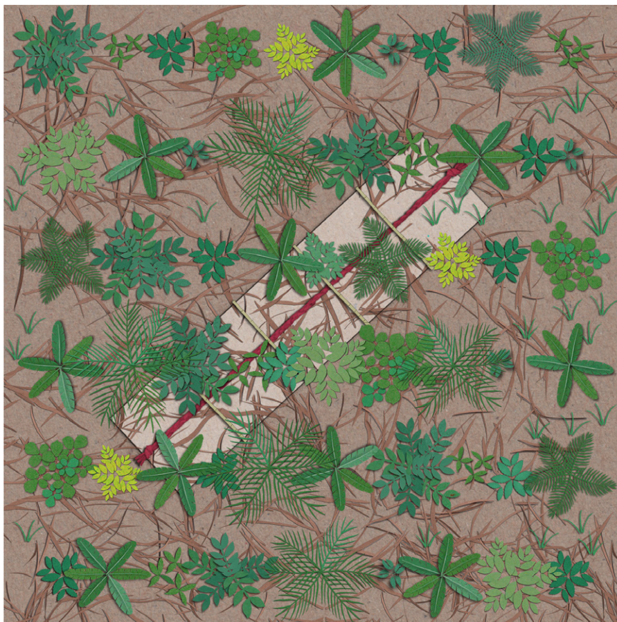
fig 3. Instalação da parcela amostral em Reserva Legal com o eixo da parcela posicionado diagonalmente às linhas de plantio ou sementeira.
